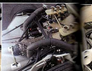
Les boas de refroidissement servent à refroidir les freins et la boîte
