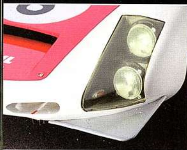
Les petits flaps latéraux sont indispensables pour l'équilibre aérodynamique de la 906
