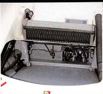
À l'avant, un petit radiateur d'huile prend place devant les pieds du pilote
